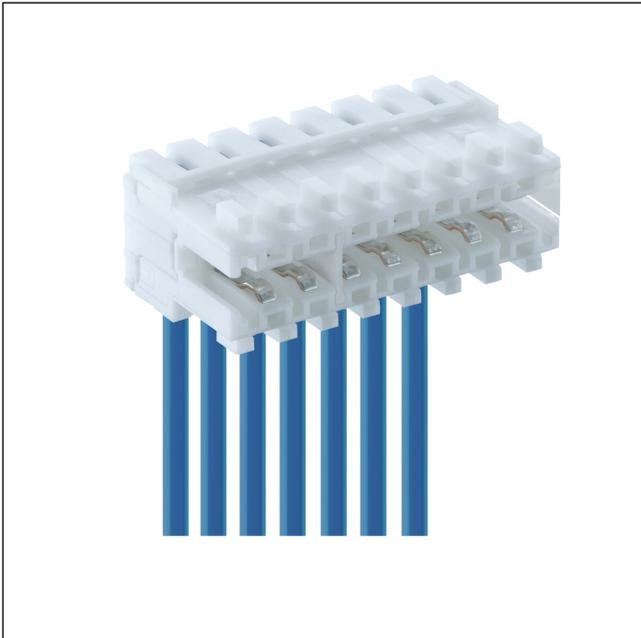
RAST-2.5-plus™-Steckverbinder für direktes Stecken, mit doppelseitiger Kodierung, in Schneidklemmtechnik (SKT), mit Verrastung auf der Leiterplatte durch Rastnocken, wahlweise mit oder ohne Kodiersteg und geschlossenen Seitenwänden
